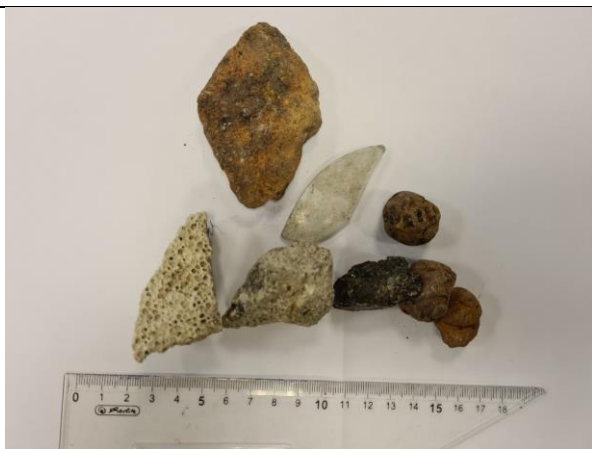
8.2.att. Jumta siltinājuma kārtā konstatētie materiāli – keramzīts, gāzbetons, būvgruži, stikls u.c.
