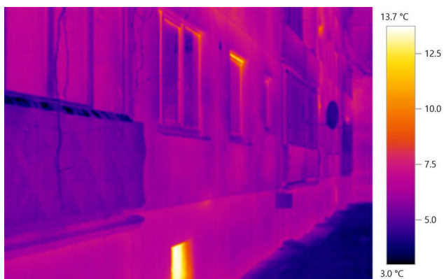
6.attēls. Ēkas dienvidu fasāde, siltuma zudui caur logu cokolā un 1.stāva loga rāmi
