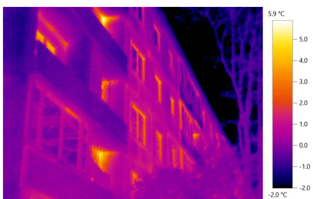
11.attēls. Ēkas fasāde, ārsienas/balkona termiskais tilts
