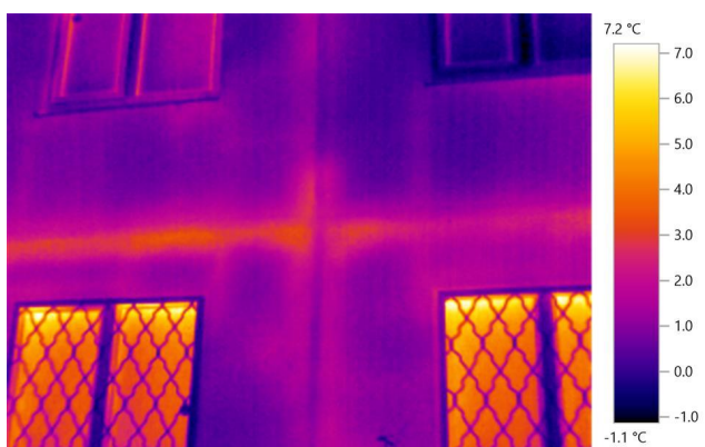
14.attēls. Siltuma zudumi caur logiem un ārsienu paneļu savienojuma vietām
