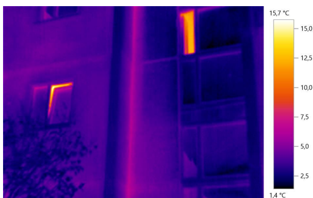
2. att. Termiskais tilts ēkas iekšējā stūrī
